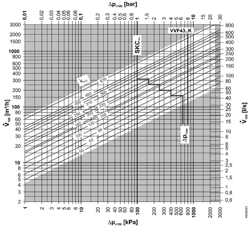
$\Delta p_{max}$  值是针对合流阀，而针对分流阀的  $\Delta p_{max}$  值参见表型号概览 第 2 页
